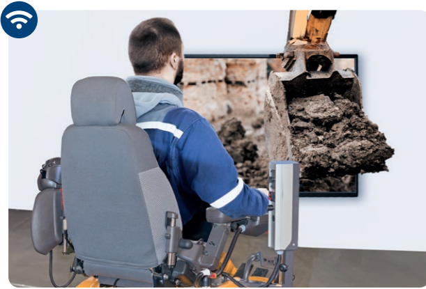
Option 1: Remote-Steuerung am 3D-Display via 5G-Technologie
