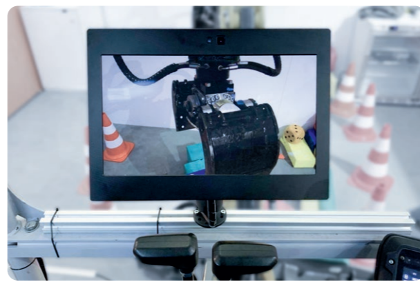
Option 2: 3D-Display direkt im Fahrzeug für die optimale Tiefenwahrnehmung
