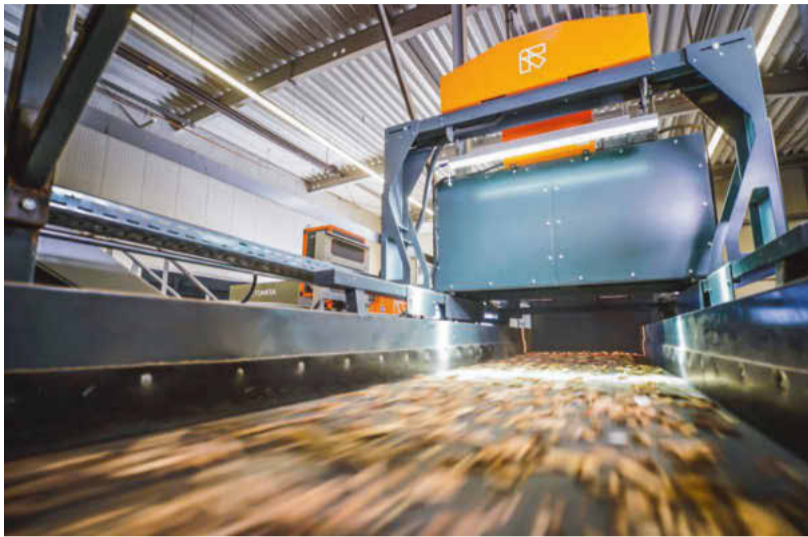
Recyclingmaschinen von Tomra kombinieren für die Abfallsortierung Nahinfrarot (NIR) und visuelle Spektrometer (VIS), um Materialien präzise und schnell nach Materialart sowie Farbe zu erkennen und zu trennen.
