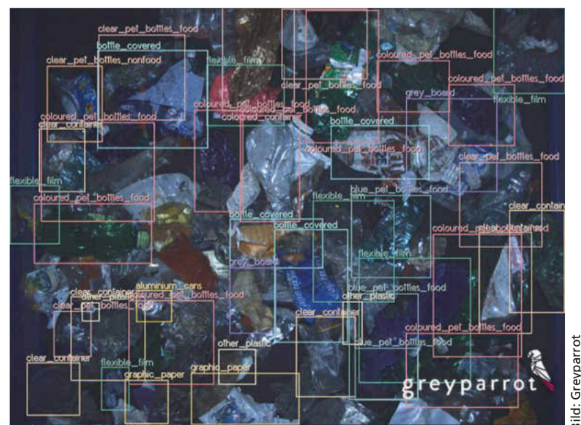
Das System von Greyparrot klassifiziert mit KI-analysierten Kamerabildern 50 Abfallarten – und das mit einer Fehlerquote von unter 1 %.
