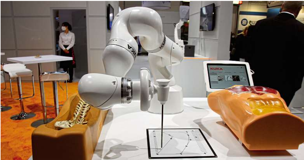
Der Leichtbauroboter LBR Med von Kuka verfügt über eine feinfühlige Sensorik, hygieneoptimierte Oberfläche und umfassende Sicherheitspakete. Halle 10, Stand A22
