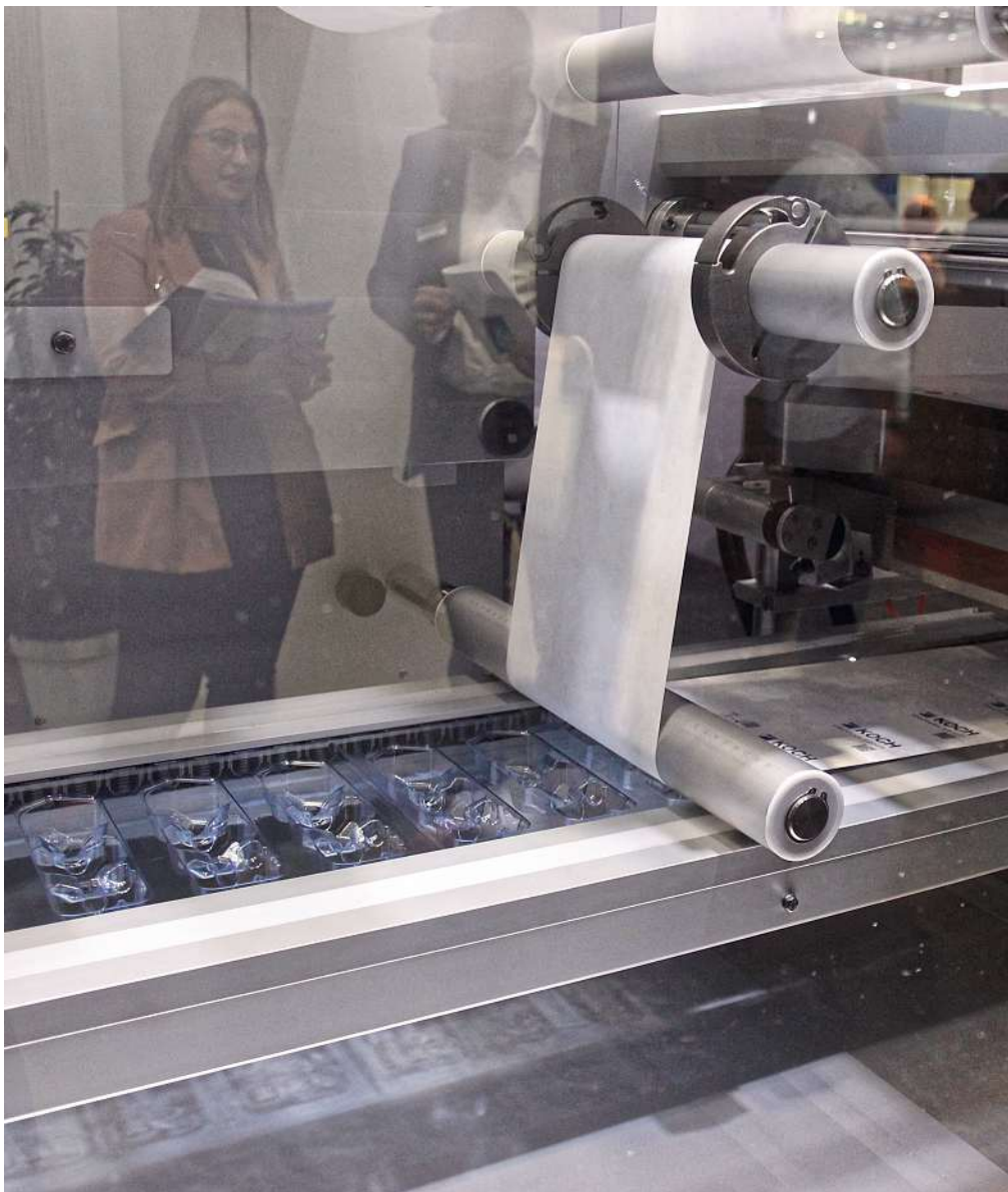
Koch Pac-Systeme präsentiert die Blistermaschine KBS-C Medplus am Stand C04 in der Halle 8a. Neu ist die Siegelnahtkontrolle.
