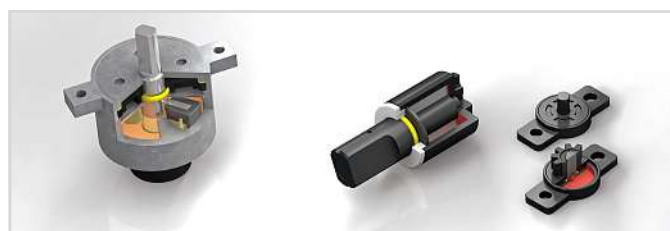
Rotationsbremsen arbeiten nach dem Prinzip der Flüssigkeitsdämpfung, wobei das Bremsmoment durch die Viskosität des Fluids und die Dimensionierung von Drosselspalte oder Drosselbohrungen bestimmt wird.
