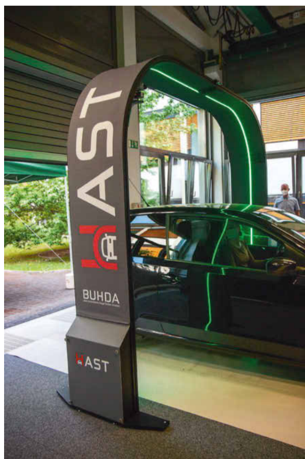
Dieses System kontrolliert glänzende oder diffus reflektierende Oberflächen komplett automatisiert.
