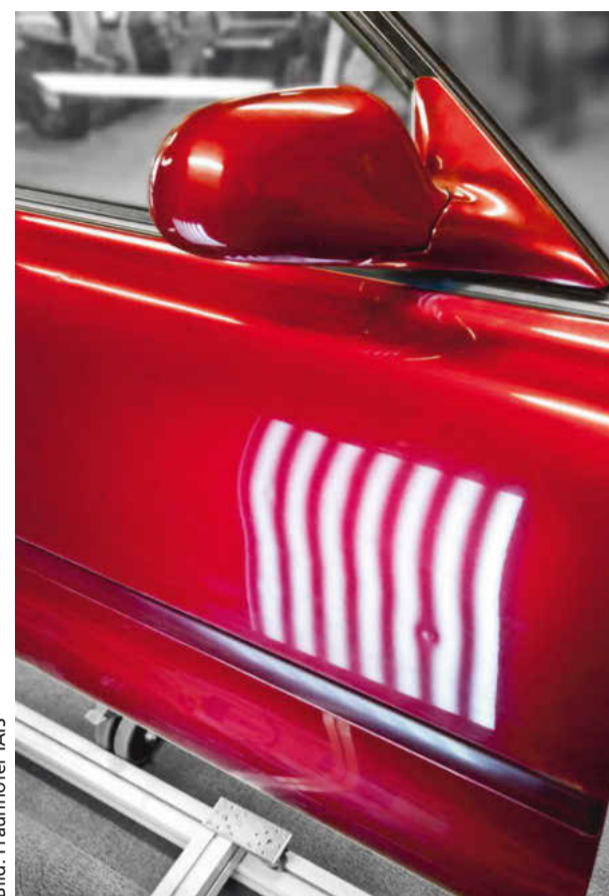
Die Deflektometrie eignet sich zur Prüfung gekrümmter spiegelnder Oberflächen – hier am Beispiel einer PKW-Tür.
