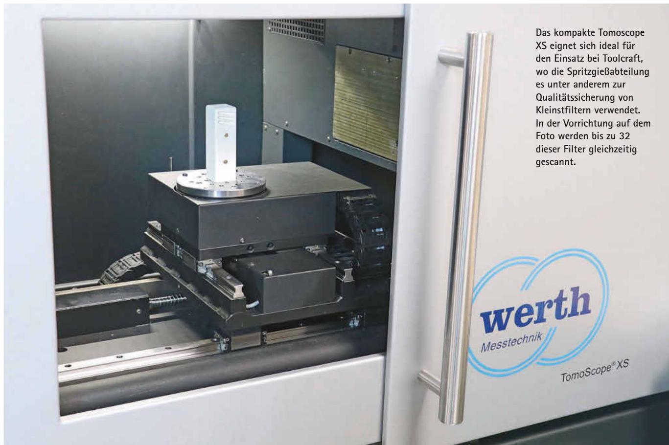
Das kompakte TomoScope XS eignet sich ideal für den Einsatz bei Toolcraft, wo die Spritzgießabteilung es unter anderem zur Qualitätssicherung von Kleinstfiltern verwendet. In der Vorrichtung auf dem Foto werden bis zu 32 dieser Filter gleichzeitig gescannt.
