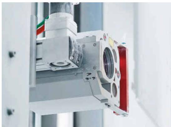
Der Messkopf mit dem Laser, einer Visualisierungskamera, dem Sensor und einer Freiblaseinrichtung ist in zwei Achsen verfahrbar und lässt sich dank der kompakten Abmessungen gut integrieren.
