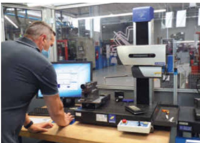
Metallverarbeiter PEL Pintossi führt Profil- und Oberflächenkontrollen direkt in der Produktion durch.
