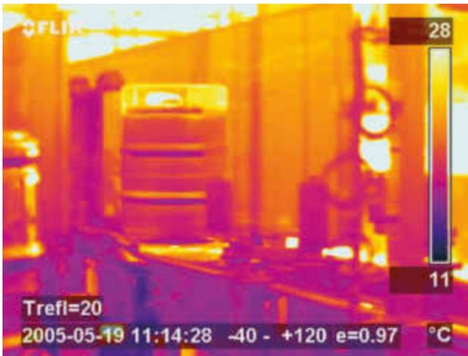
Wärmebildkameras überwachen hier die Reinigung von Bierfässern aus Metall mit einer heißen Spülflüssigkeit.
