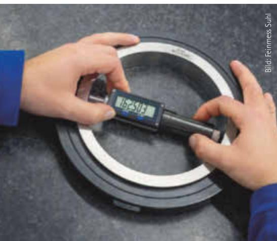
Die neue digitale Innen-Messschraube 0826 von Feinmess Suhl deckt einen Anwendungsbereich von 100 bis 5000 mm (Umschaltung auf Zoll möglich) ab. Aufgrund der verschiedenen anschraubbaren Verlängerungselemente in Endmaß-Qualität ist sie für einen breiten Messbereich nutzbar.
